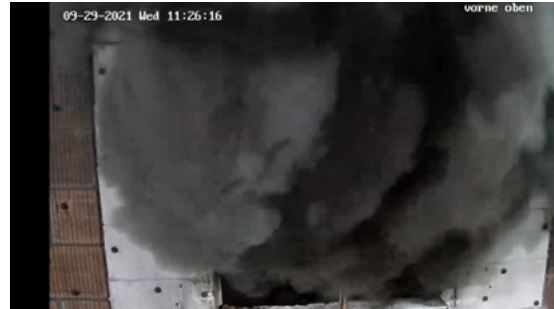
Abbildung 28: Brandraumfenster nach 2:30 min (Versuch 1, eigene Darstellung, 2022)
