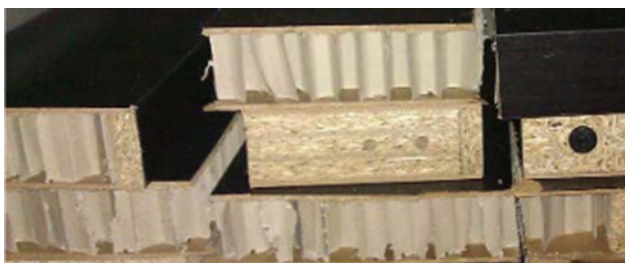
Abbildung 10: Schnitt durch zwei verschiedene Arten moderner Möbelstrukturen [1]
