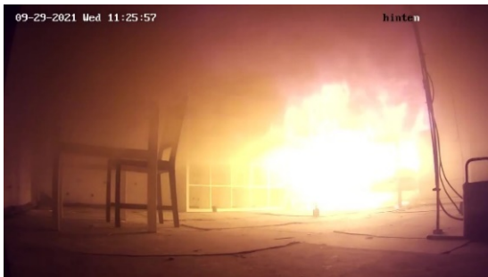
Abbildung 25: Brandraum nach 2:00 min (Versuch 1, eigene Darstellung, 2022)
