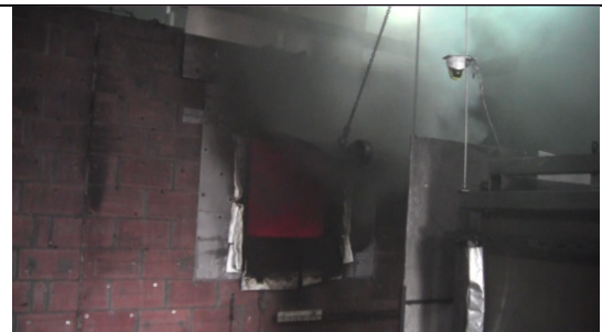
Abbildung 91: Brandraumfenster frontal nach 13:22 min (Versuch 4, eigene Darstellung, 2022)
