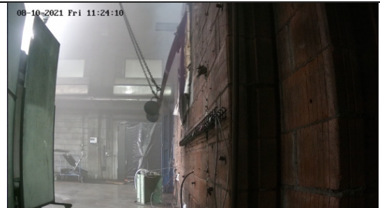
Abbildung 100: Brandraumfenster nach 20:00 min (Versuch 4, eigene Darstellung, 2022)
