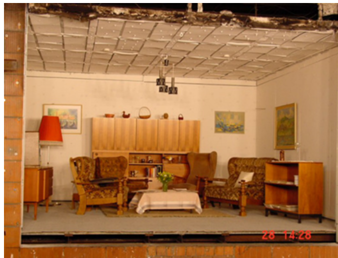
Abbildung 1: Offener Brandraum vor der Zündung [4]
