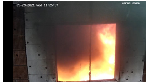
Abbildung 26: Brandraumfenster nach 2:00 min (Versuch 1, eigene Darstellung, 2022)
