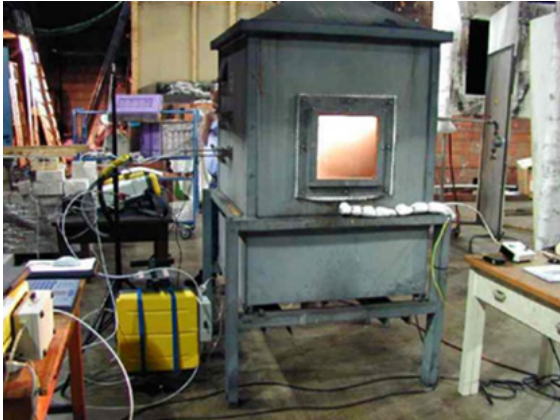
Abbildung 4: Brandkammer für Pyrolyseuntersuchungen [8]
