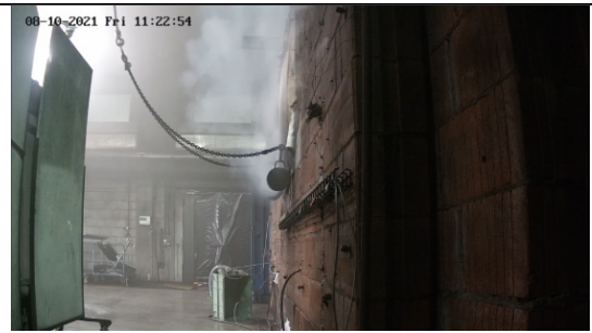
Abbildung 98: Brandraumfenster nach 18:45 min (Versuch 4, eigene Darstellung, 2022)
