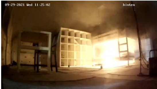
Abbildung 23: Brandraum nach 1:00 min (Versuch 1, eigene Darstellung, 2022)
