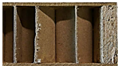
Abbildung 11: Schnitt im Detail eines modernen Möbelstücks mit Wabenstruktur [1]
