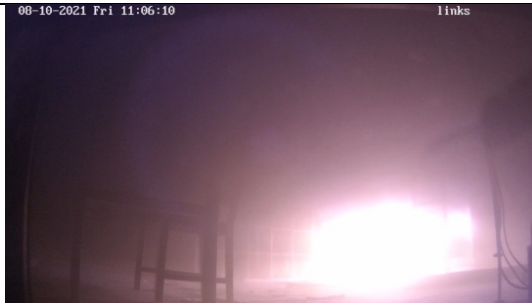
Abbildung 81: Brandraum nach 2:00 min (Versuch 4, eigene Darstellung, 2022)
